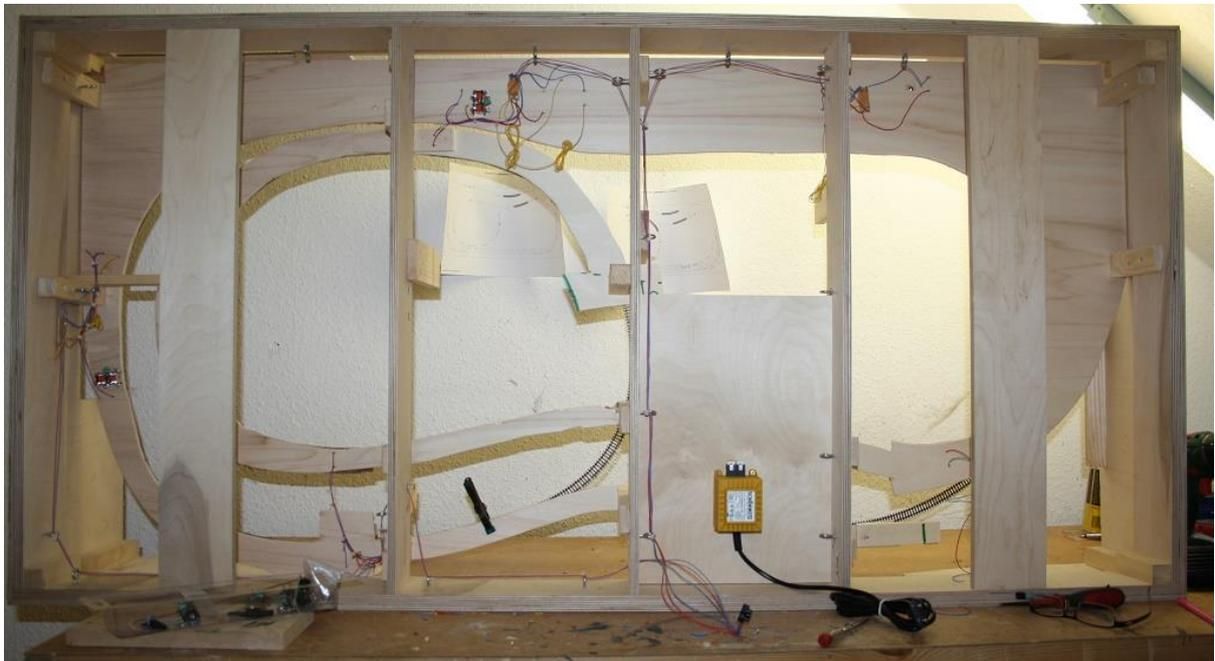
Trotz der Peco-Flexgleise, speise ich nach jeder Weiche und an jeder Lötstelle den Fahrstrom neu ein. Die Kabel werden an Lötleisten gebündelt. Hier auch ein Peco-Weichenantriebe zu erkennen.
