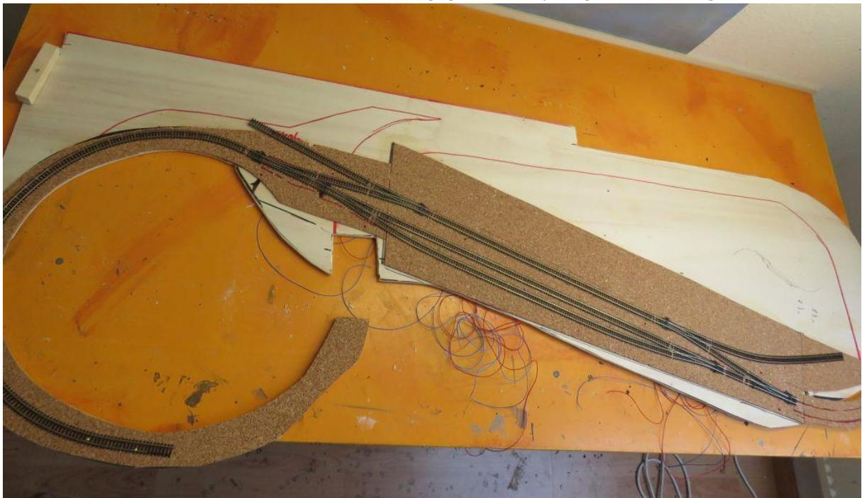
Ich arbeite mit Gleisklemmen, den Gleisschablonen von Peco und fixiere die Gleise mit Stecknadeln. Neu sind die Gleisschablonen von Modellbahn Union. Klasse Teile. Im sichtbaren Bereich löte ich die Kabel von unten an die Schienenverbinder.
