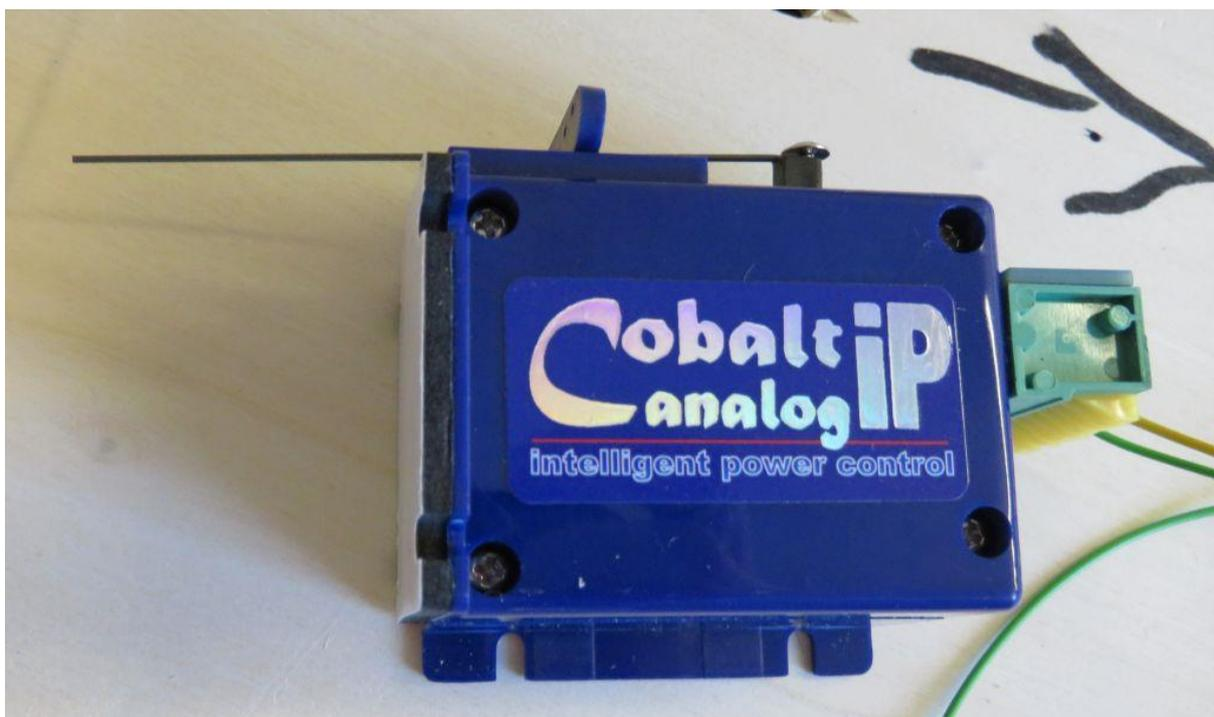
Hier mein provisorischer Schalter für die Installation. Über den Wechsel der Polarität wird der Antrieb geschaltet. Hatte ich glaube ich auch noch nicht, das Schalten der Weichen per Schalter....
