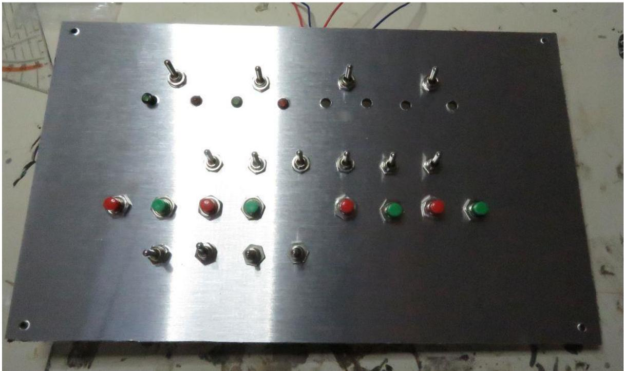
Die Weichen werden mit den Kippschaltern geschaltet. Im SBH mit optischer Rückmeldung.
